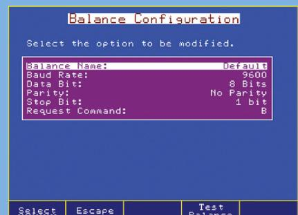
Interface de la balance configurable Intègre automatiquement la masse ou le volume de l'échantillon.
